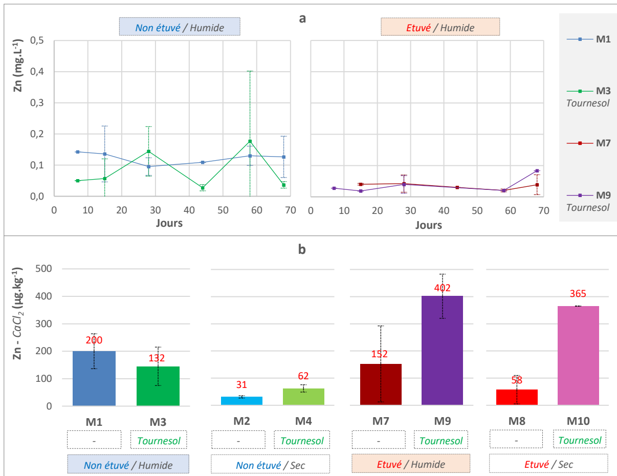
Figure 160 : Comparaison des différentes teneurs en zinc : (a) Evolution de Zn présent dans la solution du sol au cours de la campagne pour les modalités : sol non étuvé humide M1 (sans plante) et M3 (tournesol), sol étuvé humide M7 (sans plante) et M9 (tournesol) ; (b) Mesure du zinc présent dans le sol (extrait au CaCl 2 ) en fin de campagne (jour 70) pour les modalités : sol non étuvé humide M1 (sans plante) et M3 (tournesol), sol non étuvé sec M2 (sans plante) et M4 (tournesol), sol étuvé humide M7 (sans plante) et M9 (tournesol), sol étuvé sec M8 (sans plante) et M10 (tournesol)
