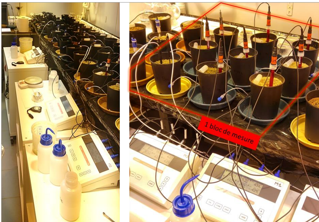
Figure 75 : Photo illustrant un cycle de mesure pour un bloc avec les multimètres MULTI 1 et MULTI 2, placés sur des chariots roulants
